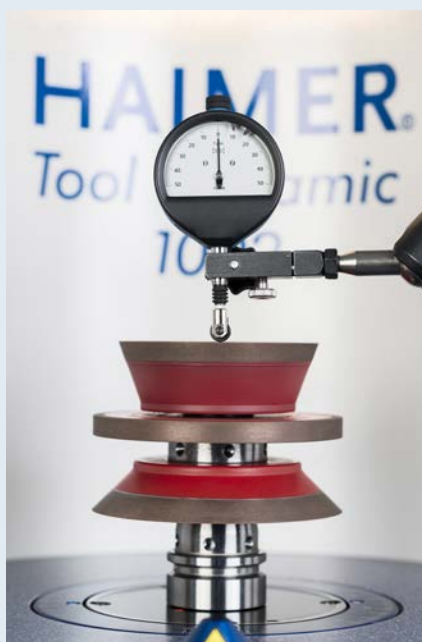
Проверка точности вращения/Axial runout check
