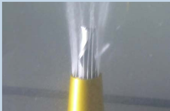
Насадки с соплами – неэффективное охлаждение, СОЖ не достигает режущей кромки Slip-on sleeve with nozzles – ineffective cooling, coolant does not reach the cutting edges
