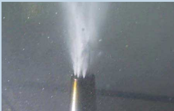
Cool Flash – эффективное охлаждение режущей кромки Cool Flash – effective cooling at the cutting edges
