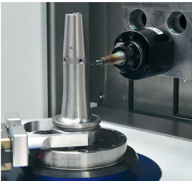
Автоматическое устранение дисбаланса с помощью CNC-обработочной единицы Automatic removal of imbalance using the CNC block
