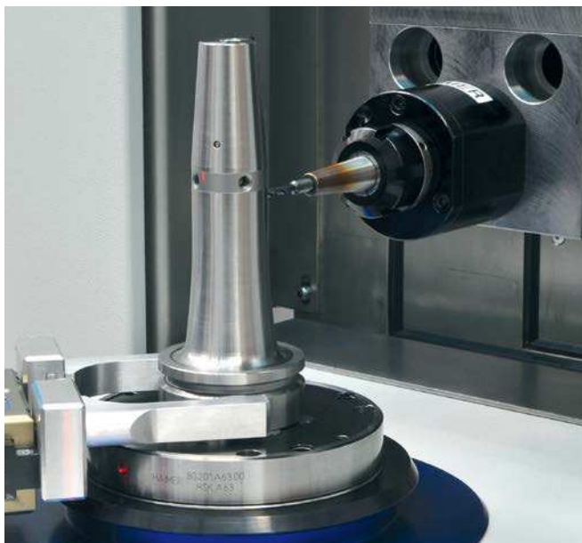
Автоматическая Бeseitigung der Unwucht durch CNC Bearbeitungseinheit Автоматическое удаление дисбаланса при помощи блока чпу
