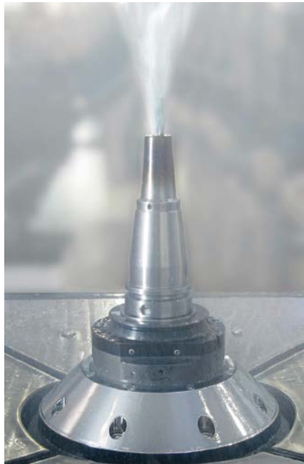
Доставка СОЖ к вершине инструмента при 18 000 об/мин. Coolant to the top of the cutting tool @ 18,000 rpm.
