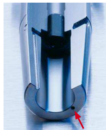
Термопатрон Shrink fit chuck
