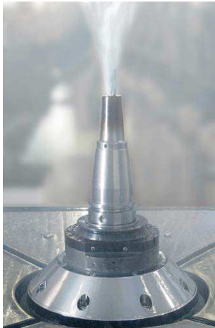
Доставка СОЖ к вершине инструмента при 18 000 об/мин.
